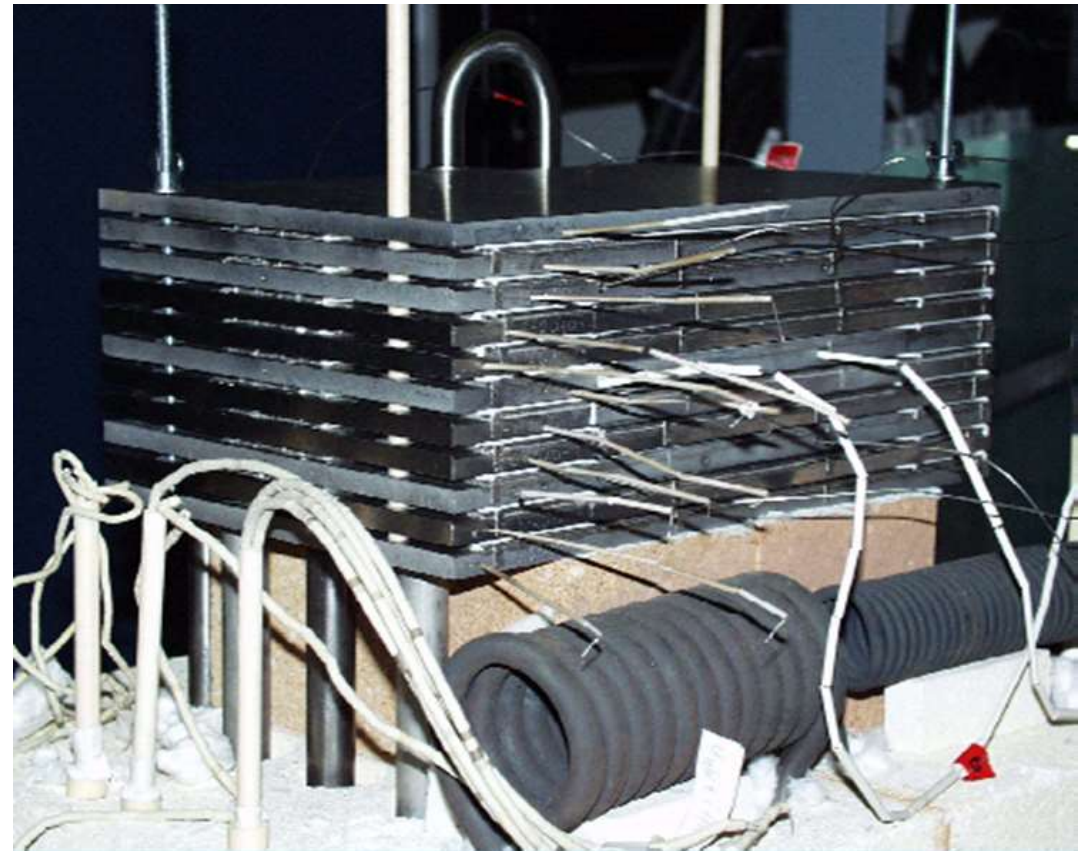
SOFC im Aufbau, inklusive Sensorik
