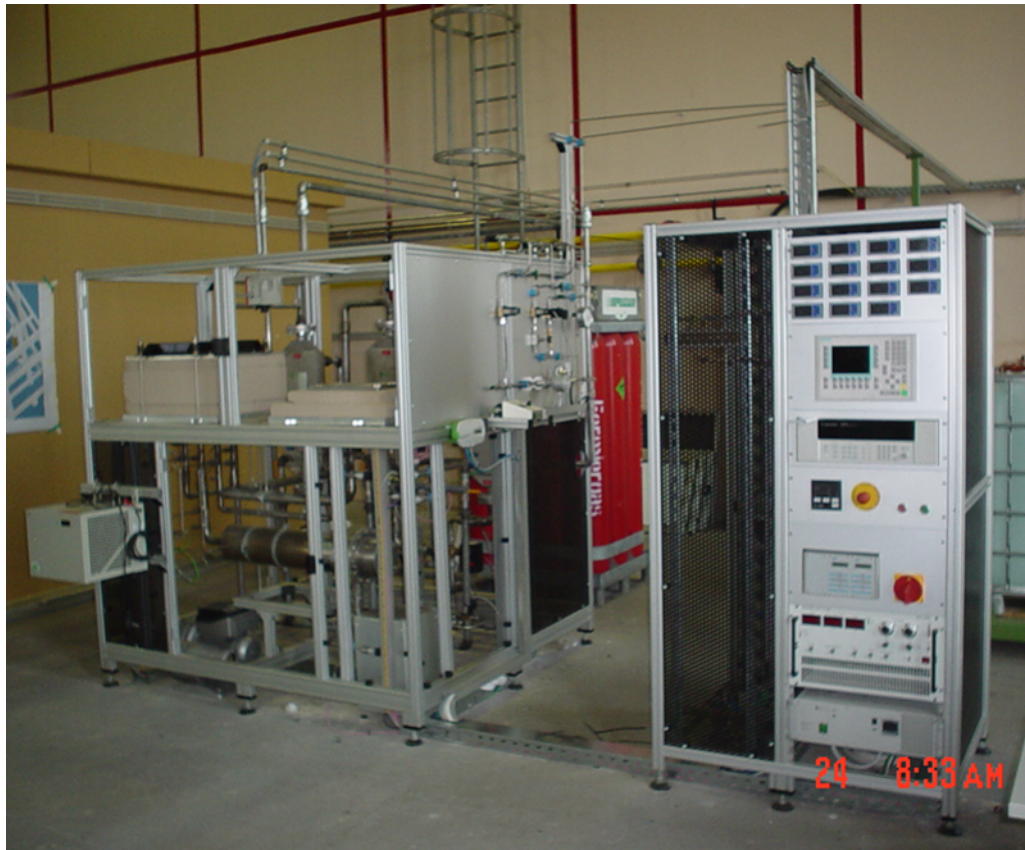
SOFC Teststand in Luisenthal
